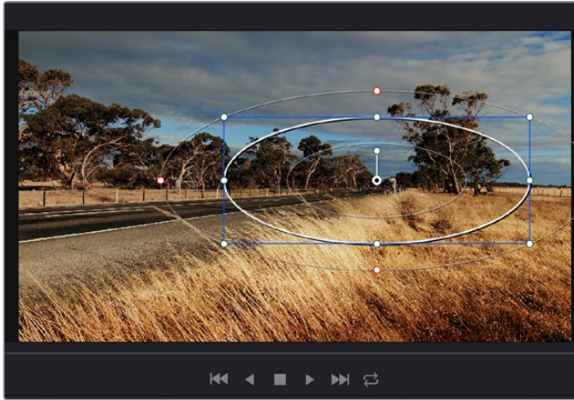
Power Windows lassen Sie in bestimmten Bereichen Ihres Bildes sekundäre Korrekturen vornehmen
