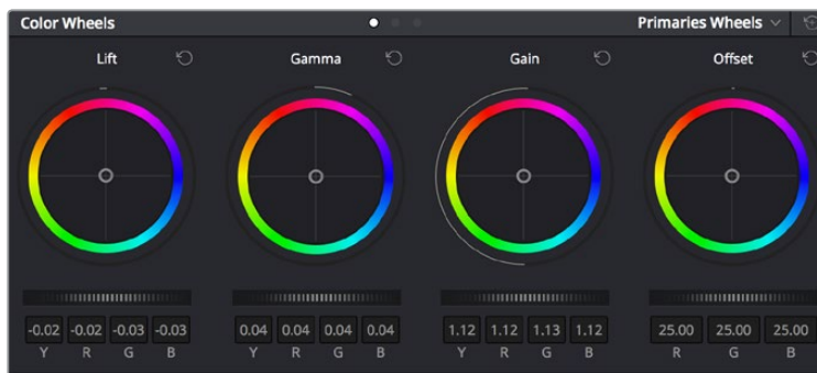
Круги Lift, Gamma, Gain и Offset предназначены для изменения параметров цвета и баланса тонов. Чтобы выполнить глобальную коррекцию всех цветов для каждой области, перетащите слайдер шкалы вперед или назад.
