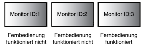
Abbildung 2 Auf der Fernbedienung ist die FERNBEDIENUNGS-ID: 3 eingestellt.
